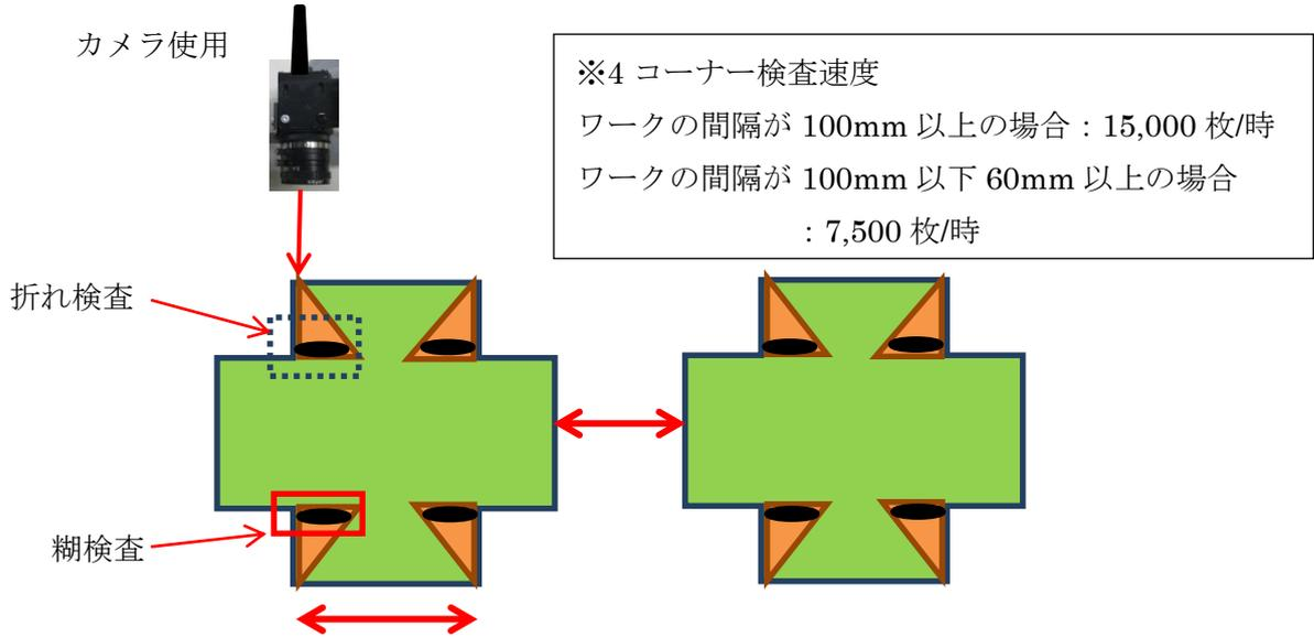
検査条件 : ワークの前の糊・折れと後の糊・折れの間隔が 30mm 以上あること
